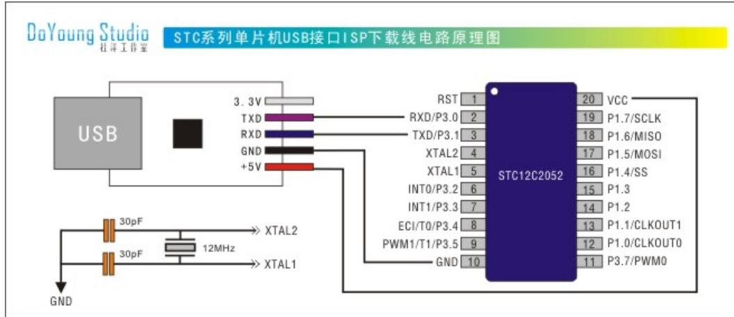
3, 检查单片机是否有接外部晶振。虽然有一些单片机之前设置的是内部 RC 时钟，即不需要外部晶振也可以下载，但如果在某次下次时使用了 STC-ISP 软件默认的外部晶体，正好单片机外部又没有接晶振，就会下载失败。请在单片机的外部加 6~35M 之间的晶振、30P 的电容（如上图），然后再重新下载试试。测试时单片机必须要加晶振！
