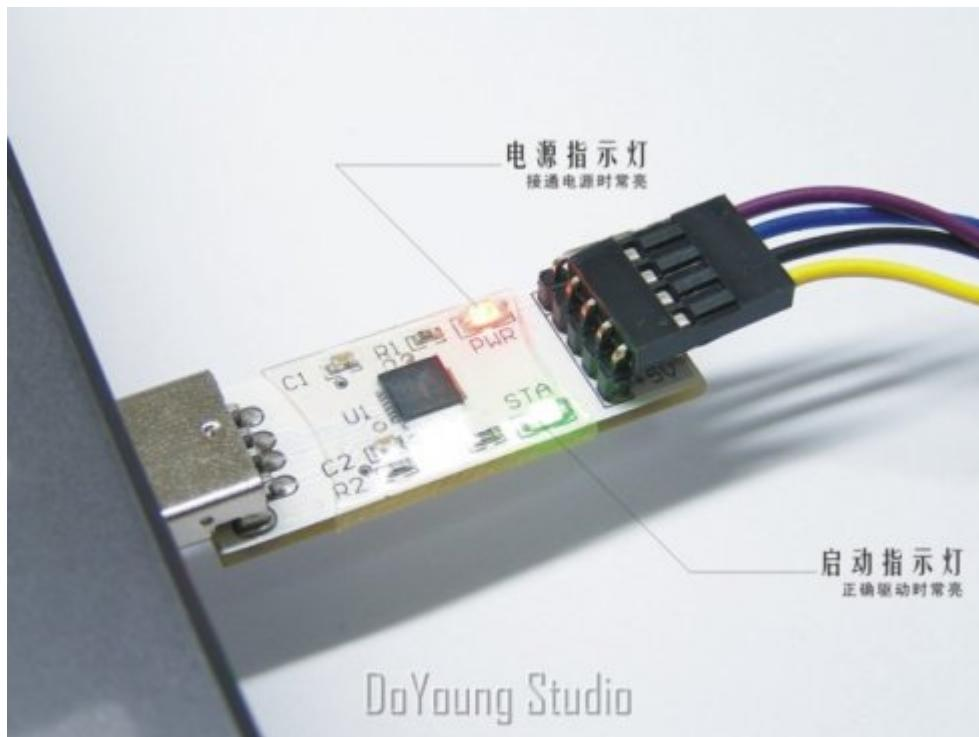
2，在控制面板—》系统—》硬件管理器中找到“端口”—》CP2101 串口，了解括号里的 COM 号。如果括号里显示 COM4，那在 STC-ISP 软件里也要选择 COM4 才行。
